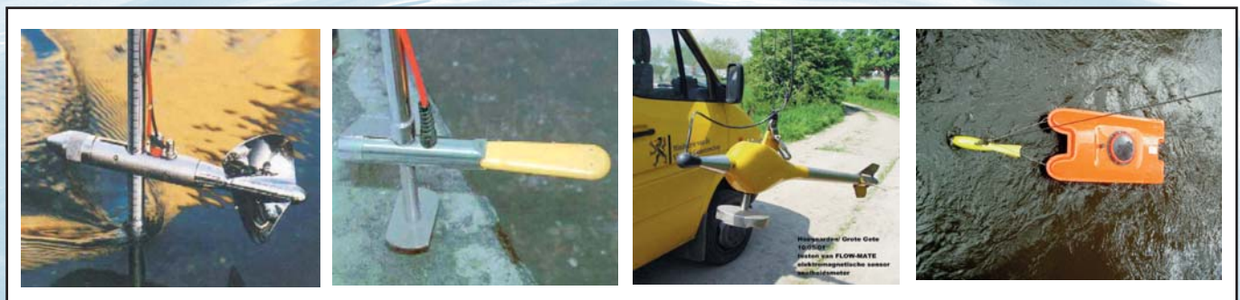
Figuur 6: Overzicht apparatuur voor de gedetailleerde snelheidsbepaling in een dwarsprofiel
