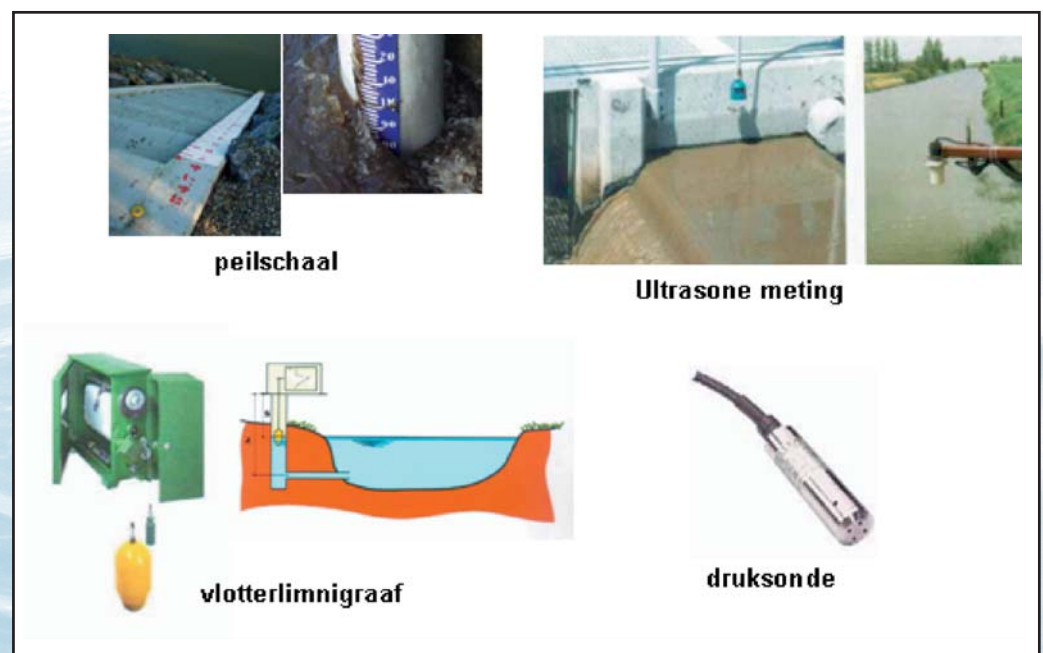
Figuur 2: Overzicht toestellen waterstandsmeting
